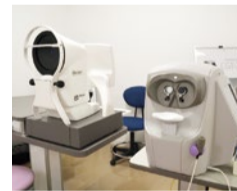
(左) iLASIK 一人ひとりに合わせたカスタマイズなレーザー屈折矯正手術が可能に。 (右) CGT-2000 近方・中間・遠方のコントラスト感度を測定でき、より確かな診断が行える。
