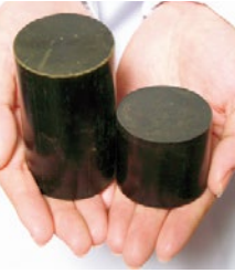
コーヒー豆のかす100%や、紙類や食品残渣(ざんさ)を混ぜたものなどで固形燃料「バイオコークス」を製造する。
