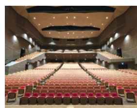
天井の改修、音響反射板の更新により、ホールの全ての座席に均質のサウンドを提供。
