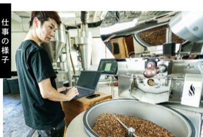
(左)15-20分の焙煎中は勝負の時。グラフと豆の様子を見ながら秒単位の温度調整をする。(右)豆のアロマをバランス良く引き出す抽出機「トリコレート」を大阪府内で唯一販売。世界のコーヒー事情にアンテナを張る山本さんイチオシ。お店で提供されるフィルターコーヒーは全てこちらを使用。
